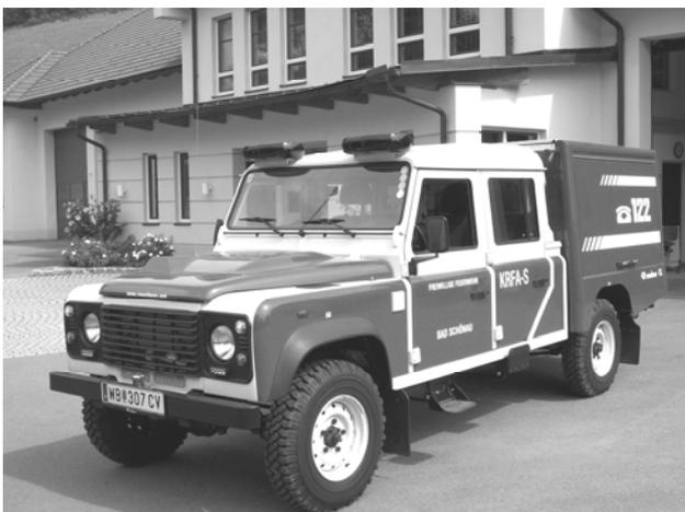
*Kleinrüstfahrzeug mit Allrad – Sonderfahrzeug (KRFA-S), aufgebaut auf Landrover*
