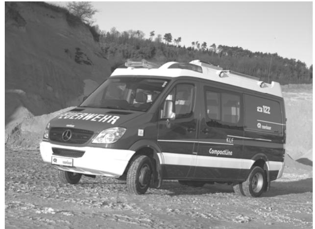
*Kleinlöschfahrzeug mit Allrad (KLFA), aufgebaut auf Mercedes Sprinter*
